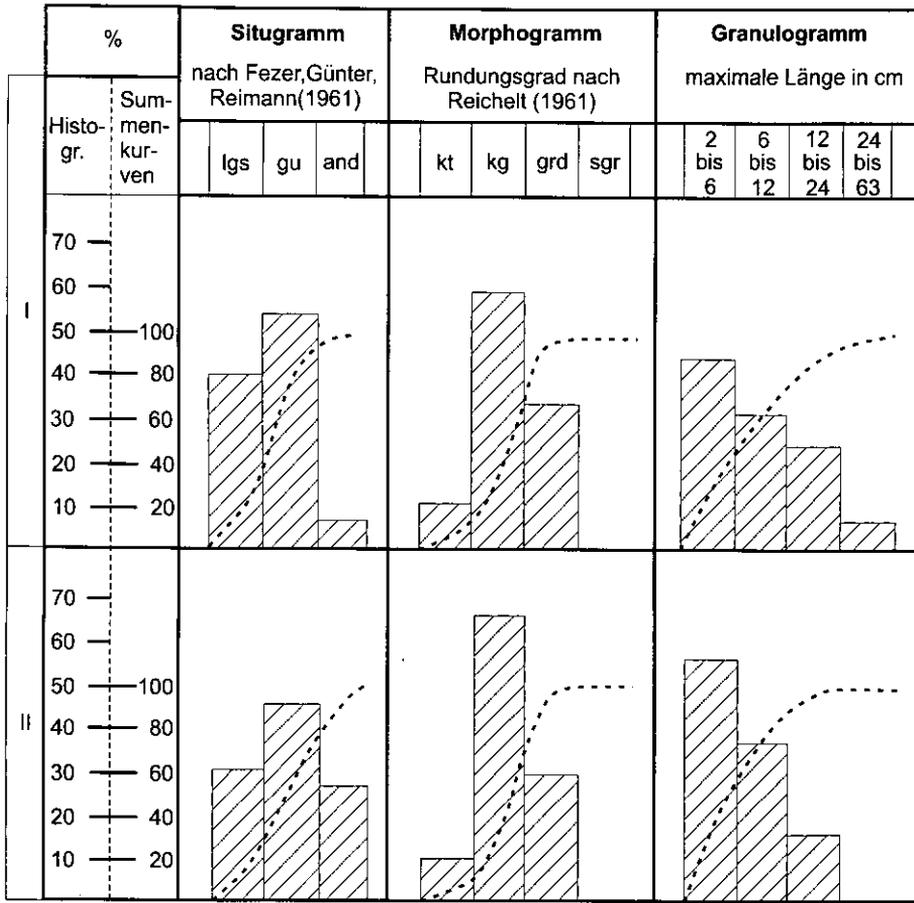
Abb. 4. Grobsedimentanalyse zweier fluvioglazialer Schotterdecken (65 cm mächtige, mittelsandig-grobsandige, lockere Schicht I mit vielen Geröllen über einer > 65 cm mächtigen, mittelsandig-feinkiesigen, kompakten Schicht II mit vielen Geröllen) aus einem ungestörten Bodenprofil im Grubenfeld Nr. 1 nahe der Grubenbrücke am Rachelseebach (804 m).
