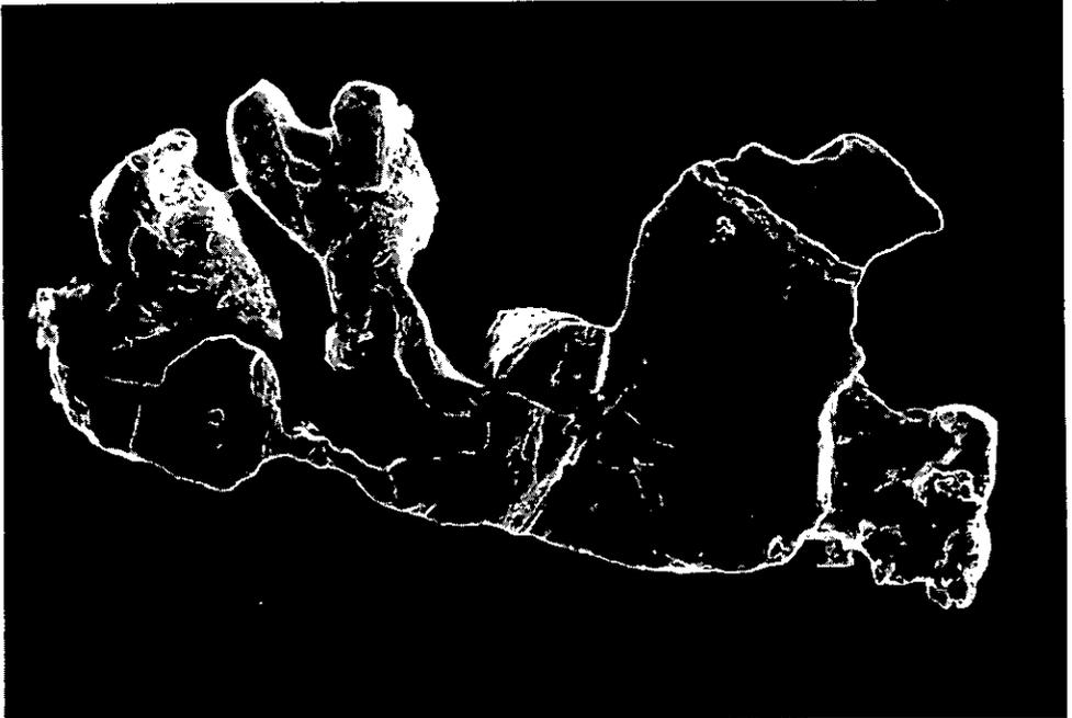
Abb. 14. Löchrig-poröses Goldkorn aus der ursprünglichen myrmekitischen Verwachsung von gediegenem Gold und gediegenem Bismut. – REM-Mikrofoto, Bildbreite: ca. 0,3 mm
