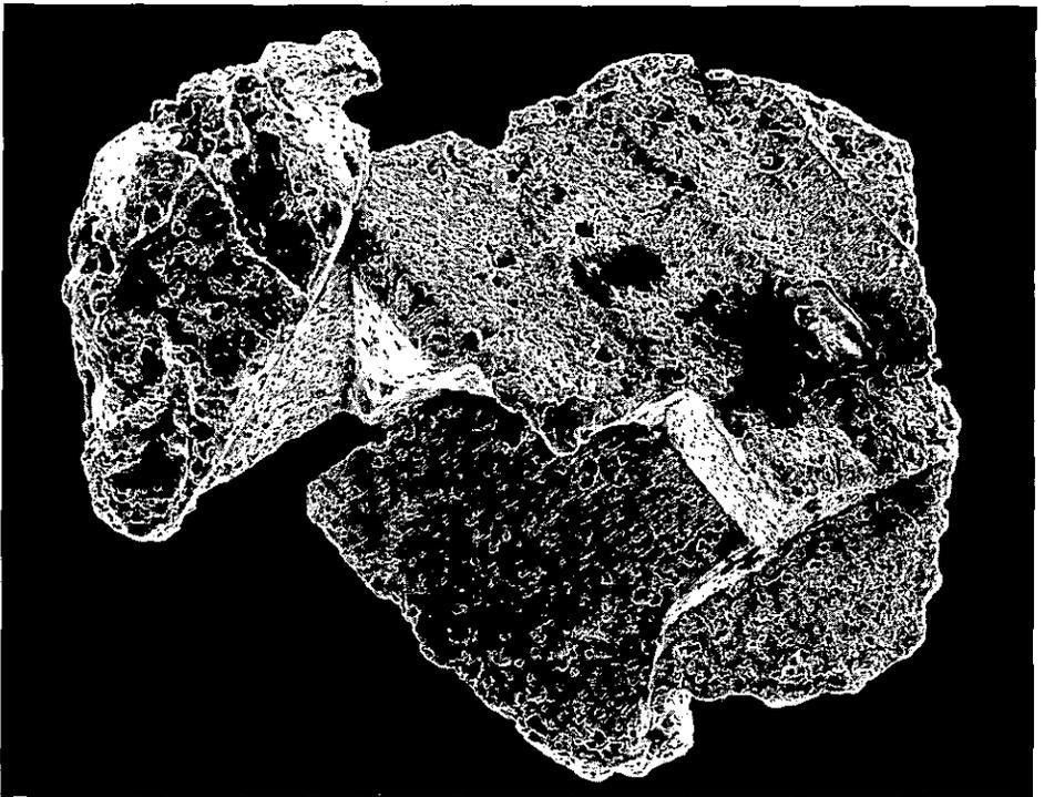
Abb. 4. Goldkorn mit teilweise ausgebildeten Kristallformen aus dem Eisenberntreuter Bach, Slg. HARTL. REM-Foto, Bildbreite: 0,7 mm.
