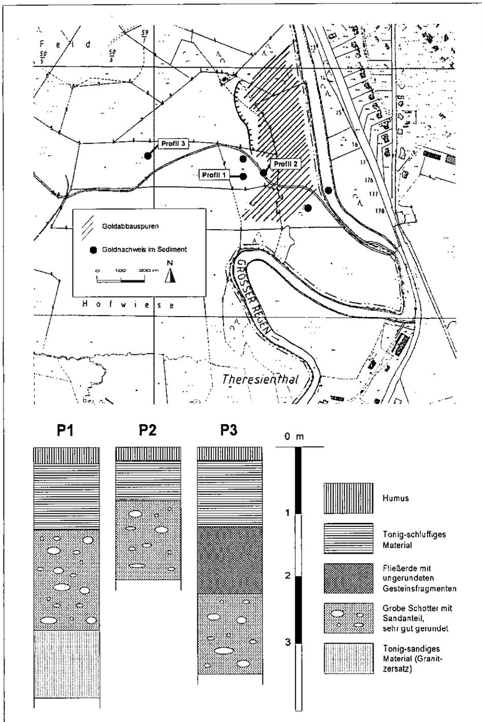
Abb. 3. Lage und Aufbau der im Bereich des Gewerbegebietes Fürhaupten Nord aufgenommenen Profile und Position der Probenpunkte (mit Angaben zum Goldnachweis).
