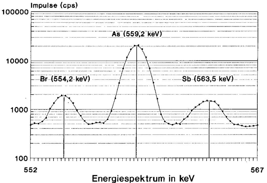
Abb. 6. Ausschnitt aus einem Spektrum einer Probe von Hornzahnmoos (Probe 101) mit Arsenpeak bei 559,2 keV, links und rechts davon treten Brom bzw. Antimon auf.
