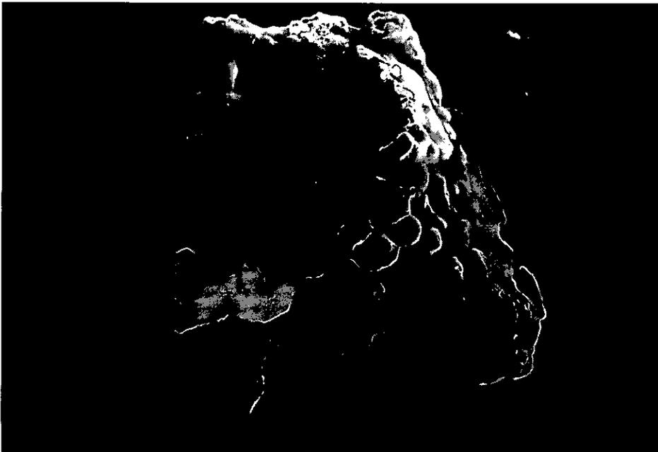
Abb. 13. Goldkorn mit Kristallform (links unten) und schaumig-poröser Struktur aus der myrmekitischen Verwachsung mit Bismut. – REM-Mikrofoto, Bildbreite: ca. 0,3 mm.
