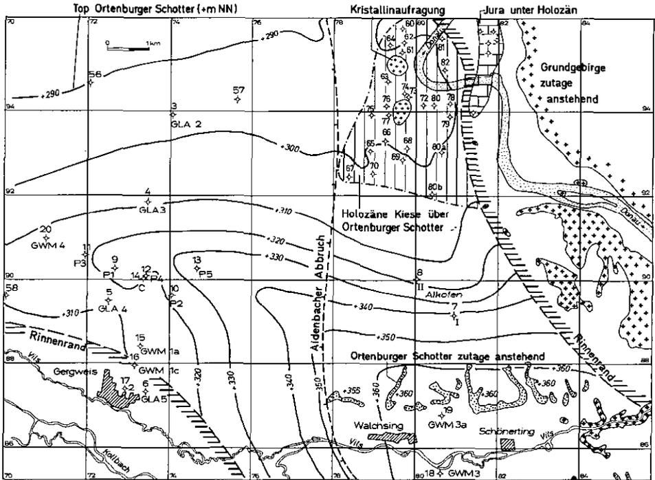
Abb. 18. Revidierter östlicher Rinnenrand des Ortensburger Schotter entlang der Donau nördlich von Pleinting mit Lage der Bohrungen (siehe Tabelle 2). Das Gebiet, in dem holozäne Kiese in direktem Kontakt zum Ortensburger Schotter lagern, ist senkrecht schraffiert (aus: UNGER 1995: 27, Abb. 2).
