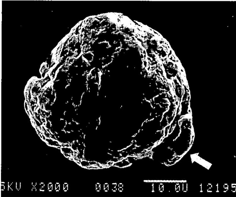
Abb. 18. Gerundetes, kugeliges Goldkorn aus dem Epigneis am Fürstenstein (Goldberg) mit einer für Seifengoldkörner typischen Umbiegung eines Kornfortsatzes (s. Pfeil; REM-Aufnahme, Objektgröße = 0,04 mm, Probe 1219).
