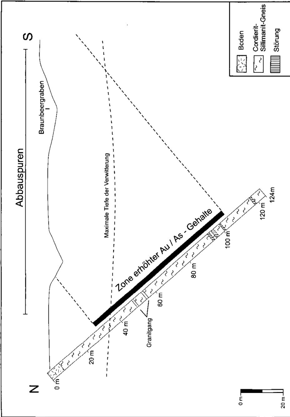
Abb. 5. Petrographisches Profil durch die Kernbohrung KB2 am Oberlauf des Braunbeergrabens mit der Projektion des vererzten Bereichs auf die Oberfläche.
