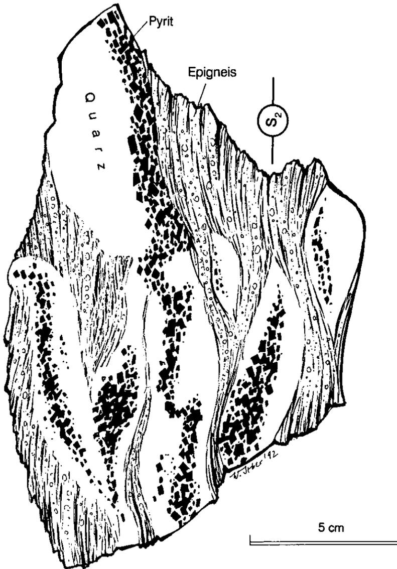
Abb. 22. Schematische Skizze eines gesägten Lesesteins von der Pyrit-Vererzung an der „Goldenen Krone“. Die Pyrit-Quarz-Gänge sind parallel bis subparallel in das Hauptschieferungsgefüge ( $S_2$ ) des Epigneises „eingeschichtet“.
