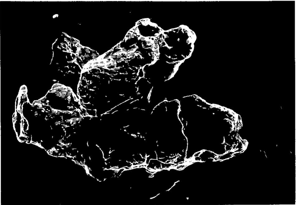
Abb. 11. Kantig-gezacktes Goldkorn wohl aus einer Verwachsung mit Arsenopyrit. – REM-Mikrofoto, Bildbreite: ca. 0,2 mm.
