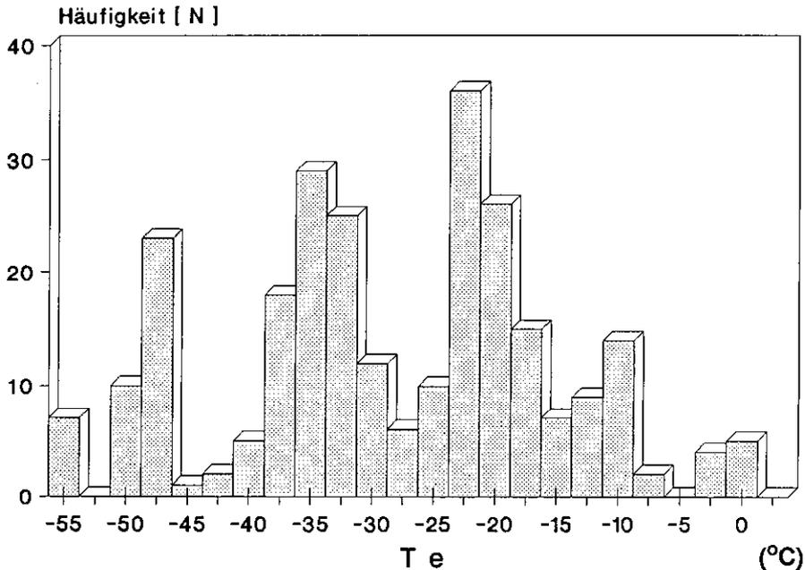
Abb. 9. Temperaturhistogramm der ersten Schmelzbildung  $T_c$  der wässrigen und  $\text{CO}_2$ -führenden Flüssigkeitseinschlüsse.
