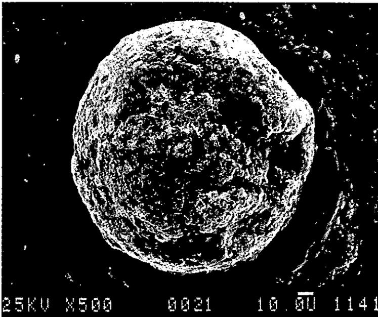
Abb. 8. Kugelförmiges Goldkörnchen aus dem Zoppatenbach in Brandholz, das seine Entstehung wahrscheinlich den dortigen, historischen Goldschmelzversuchen verdankt (REM-Aufnahme, Objektgröße = 0,15 mm, Probe 1141).
