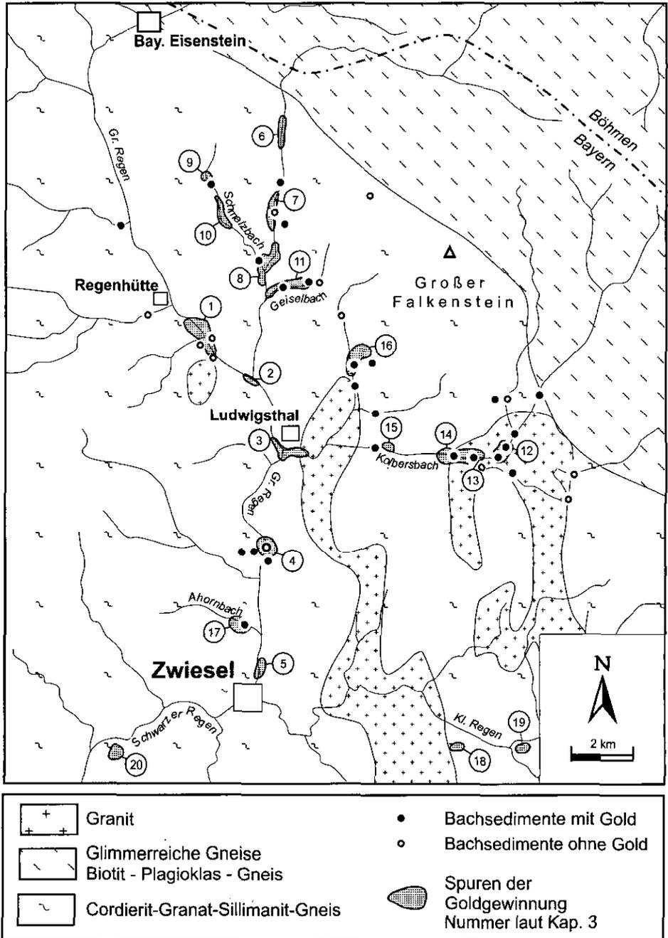
Abb. 1. Geologische Übersichtskarte des Falkensteinmassivs zwischen Zwiesel und Bayerisch Eisenstein mit Lage der historischen Goldabbaue und Ergebnissen der Bachsedimentprospektion.
