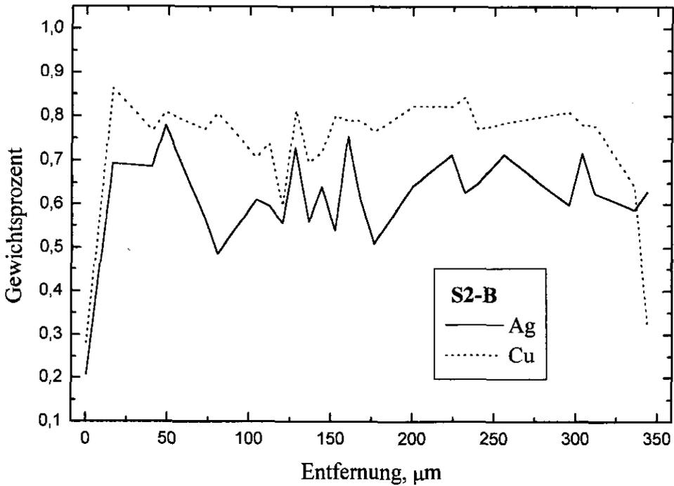
Abb. 10 (oben) Polierter Anschliff vom kompakten Goldkorn S2 (vgl. Abb. 8). Sekundärelektronenbild, Bildbreite 1 mm. – (unten) Profilmessung durch Goldkorn S2 (Typ A'), Meßpunkte alle 5  $\mu\text{m}$ .
