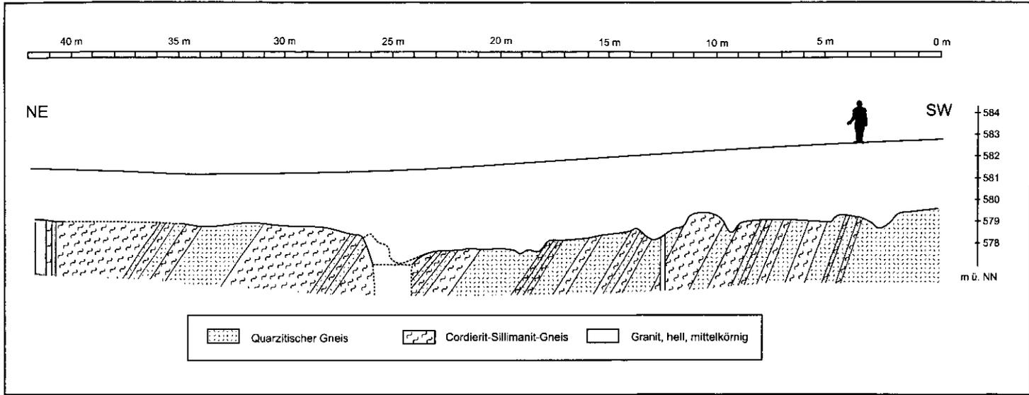
Abb. 9. Geologisches Profil durch den Baggerschnitt südöstlich Unterlangau.
