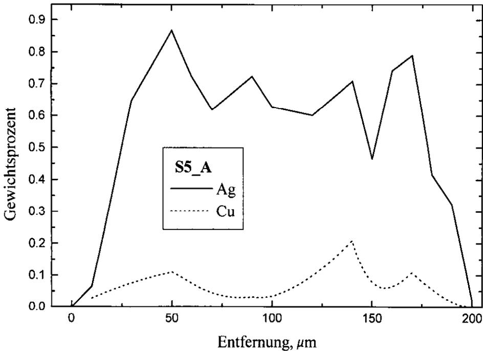
Abb. 13. Mikrosondenmeßprofil durch Goldkorn S5 (Typ C) aus einem Strudelloch der Steinklamm, Meßpunkte alle 5  $\mu\text{m}$ .
