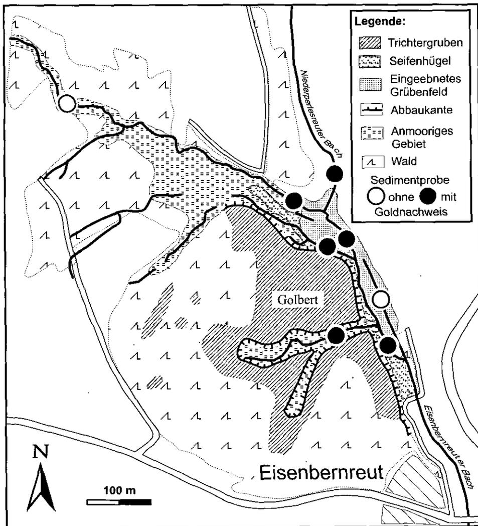
Abb. 7. Lage und Ausdehnung der Bergbauspuren der historischen Goldgewinnung am Eisenberneuter Bach, mit Ergebnissen der Bachsedimentprospektion.
